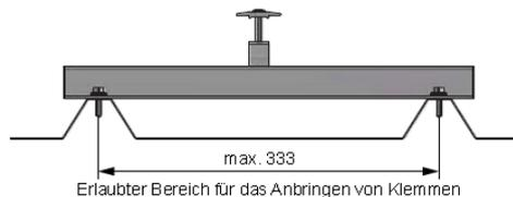
Abbildung 1: Klemmbereich auf Trapezschiene
