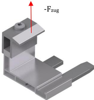
Abb. 8: Vektoren des Widerstands der Zusatzklemme unten
