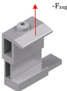
Abb. 9: Vektoren des Widerstands der Zusatzklemme oben
