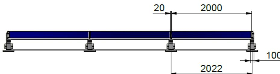
Abb. 15: Beispiel – Ansicht Aufbau mit Modulen 2000mm x 1000mm
