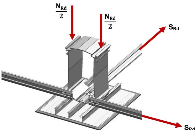
Abb. 2: Vektoren der Widerstände der Abstützung hoch MSP-FR-EW-SH
