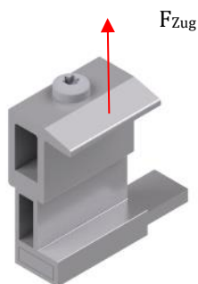
Abbildung 10: Vektoren des Widerstands der Zusatzklemme oben MSP-FR-HC/B
