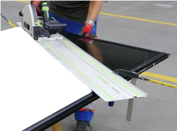
Abb. 8: Zuschnitt Blindmodul mit Handkreissäge
