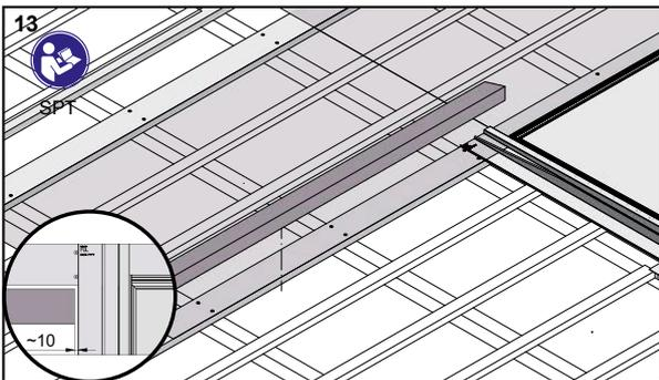
Ausgleichsbohle für Eckmodul setzen
