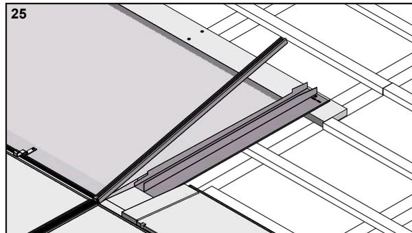
Kurzes Seitenblech und Randprofil montieren
