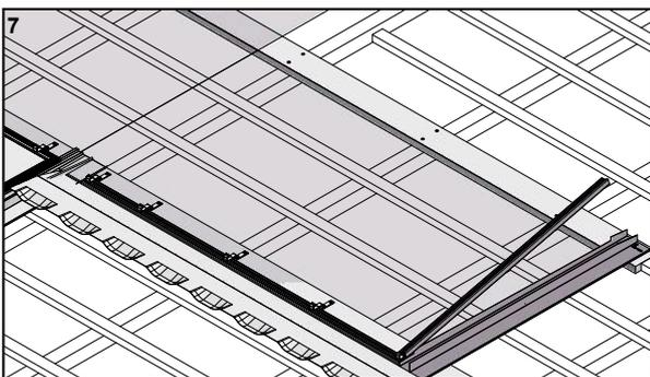
Seitenblech und Randprofil rechts montieren
