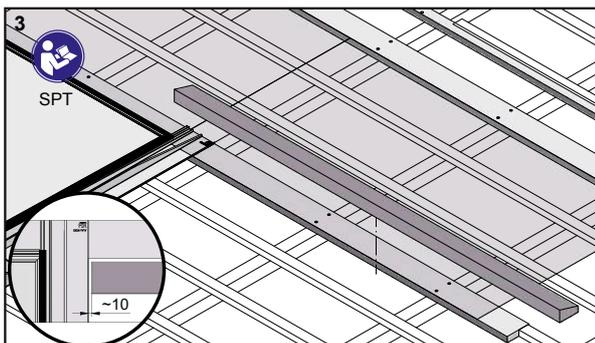
Ausgleichsbohle für Eckmodul setzen
