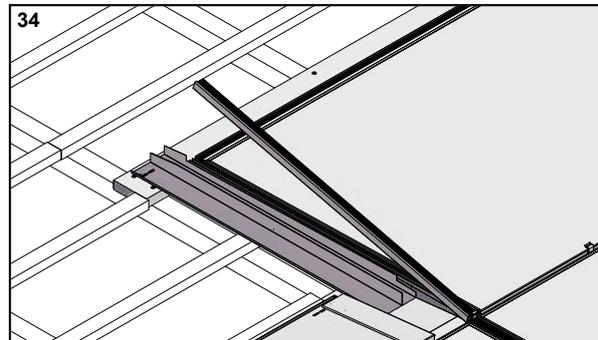
Kurzes Seitenblech und Randprofil montieren
