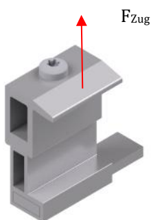
Abbildung 10: Vektoren des Widerstands der Zusatzklemme oben MSP-FR-HC/B
