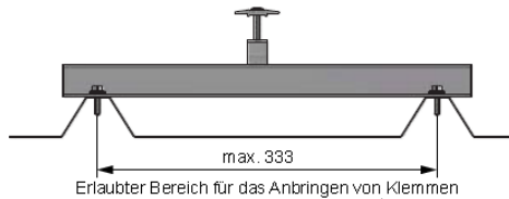
Abbildung 1: Klemmbereich auf Trapezschiene
