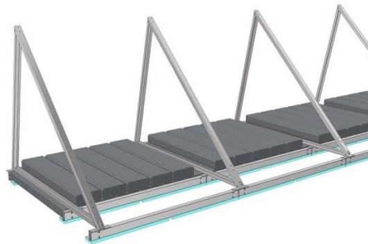
Kollektorständer ausrichten, ev. mit 10 mm dicken XPS-Platte unterfüttern. Die Kollektorständer müssen in einer Linie und in gleicher Höhe montiert sein. Um dies zu erreichen, muss geschifft werden
