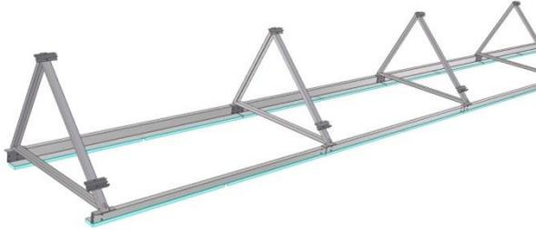
Die Kollektorständer ausrichten, ev. mit 10 mm dicken XPS-Platten unterfüttern. Die Kollektorständer müssen in einer Linie und in gleicher Höhe montiert sein. Um dies zu erreichen, muss geschifft werden.
