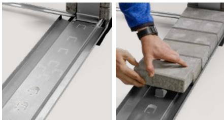
Für exponierte Lagen garantiert die Ballastfixierung höchste Sicherheit der Ballaststeine in Längs- und Querrichtung. Sie wird werkzeuglos eingelegt. Dank der flexibel positionierbaren, vorgestanzten Laschen können die Ballaststeine präzise und lückenlos fixiert werden, passend zur berechneten Ballastmenge.
