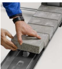
Pour les emplacements fortement exposés aux intempéries, la fixation du lest garantit une sécurité maximale des blocs de lest dans le sens longitudinal et transversal. Elle s'insère sans outil. Les languettes pré découpées et positionnables de manière flexible permettent de fixer les blocs de lest avec précision et sans espace, en fonction du lestage calculé.
